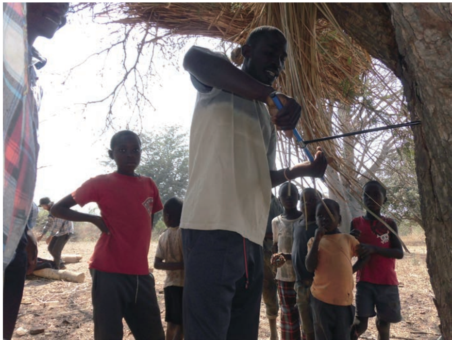
10 / 調査補助のジェームズさんが成長錐を使って、年輪を採取する。
