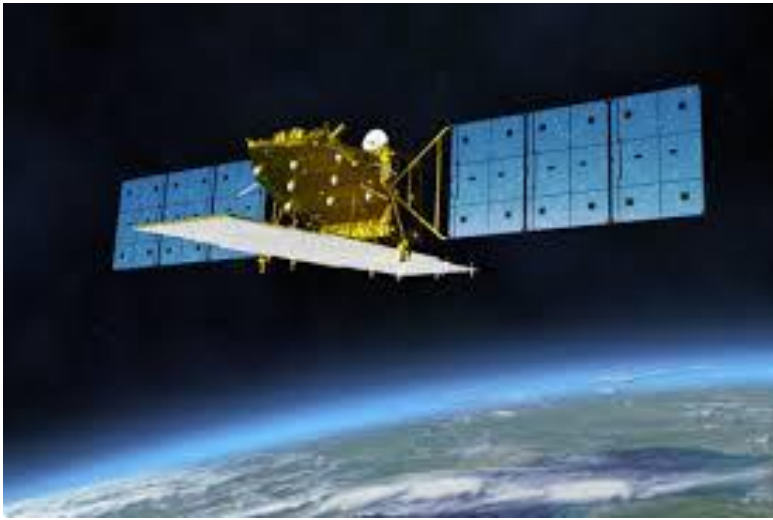
合成開口レーダ衛星 だいち2号 (ALOS-2)
